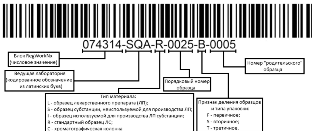
Рис. 2. Структура штрих-кода для идентификации образцов ЛС
