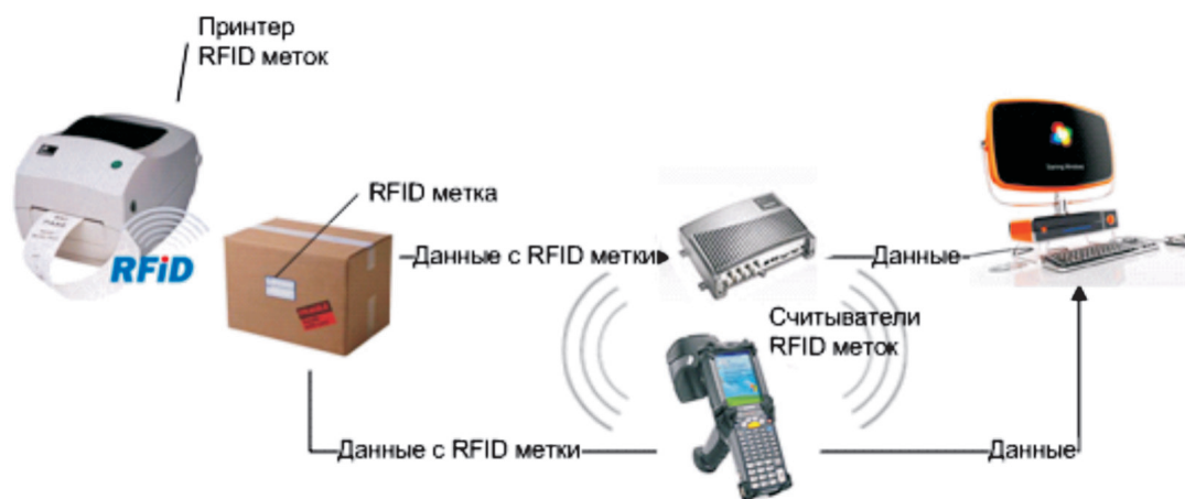
Рис. 1. Схема работы RFID системы
